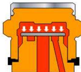
Пар движется с высокой скоростью и создает под диском область с низким давлением. Диск прижимается вниз и закрывает конденсатоотводчик. Конденсат над диском вскипает, образуя пар вторичного вскипания. За счет большей площади контакта, диск удерживается паром.
